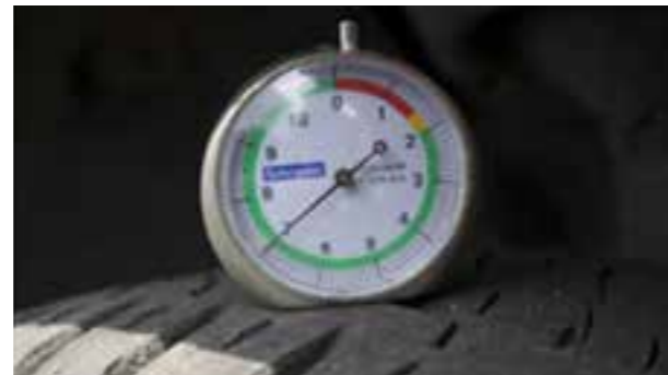
Reifen: Profiltiefe \geq 7 mm (ERFÜLLT) Anmerkung: Der Reifenverschleiß wird in der am meisten abgenutzten Profilirille am Reifen gemessen.
