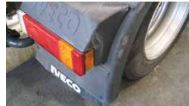
Tiefe Kratzer und Verformungen
