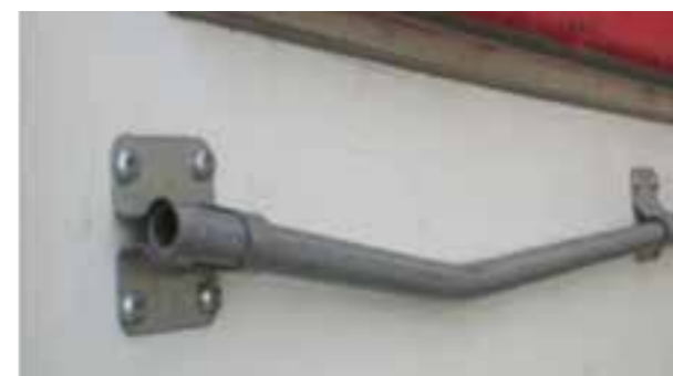
🔧 Polsterung und Stangen: Stangen und Polster verformt, können auf wirtschaftliche Weise repariert werden
