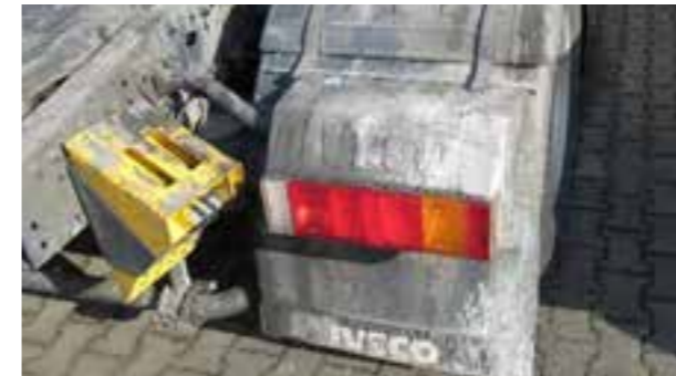
Starke Verfärbung durch chemische Elemente
