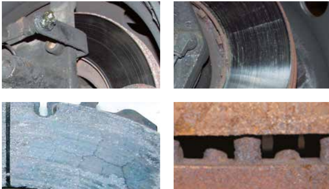
Normaler Zustand, dem Alter und der Laufleistung des Fahrzeugs entsprechend Bremsbelagdicke > 30 %
