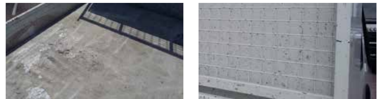
Spuren von Beton oder chemischen Produkten, die \geq ¼ der Oberfläche des Trichters bedecken
